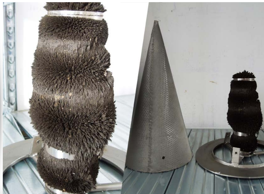
esempio di polvere nera umida trovata nel cono
