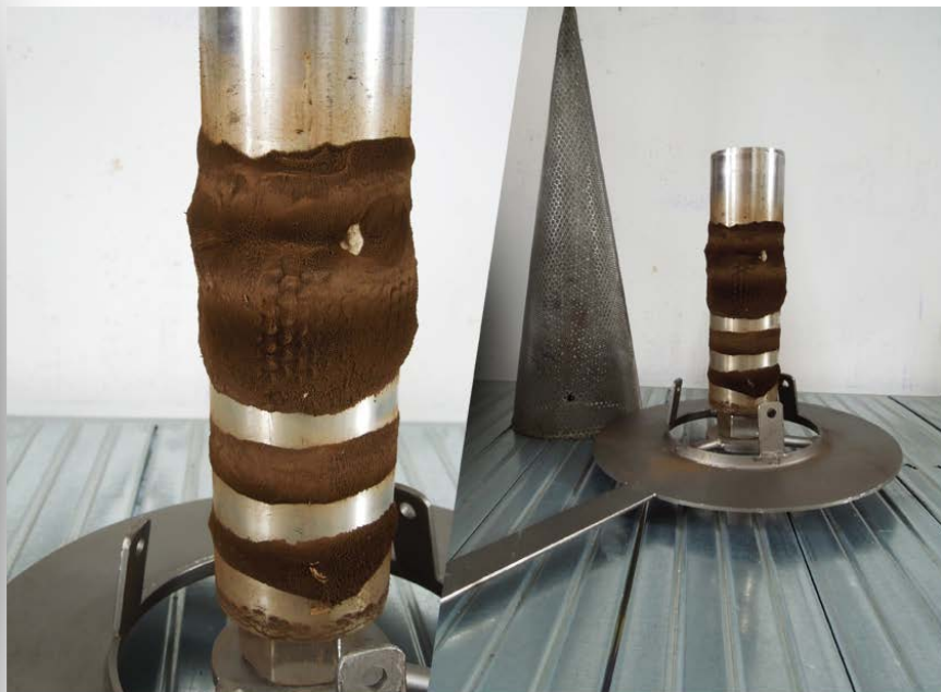
esempio di polvere nera asciutta trovata nel cono
